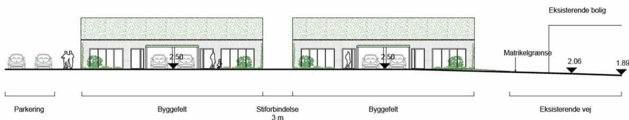
Illustration 1: Tværsnit af terrænregulering i forbindelse med etablering af den nordlige overkørsel til lokalplanområdet.
