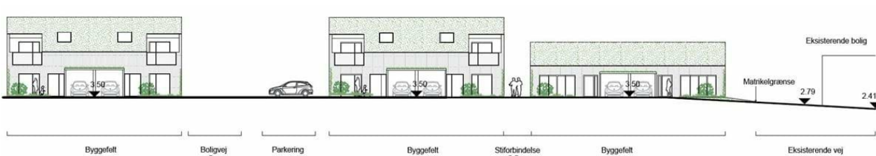
Illustration 2: Tværsnit af terrænregulering i forbindelse med etablering af den sydlige overkørsel til lokalplanområdet.
