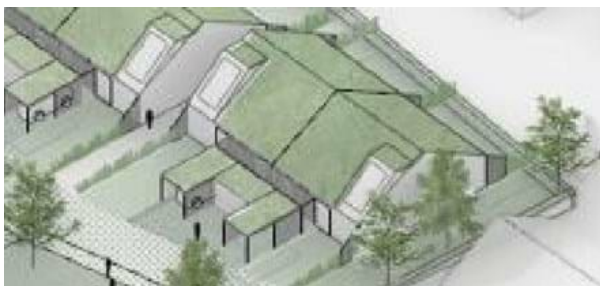
Figur 5 Princip illustration, som viser et hævet tagvindue.
