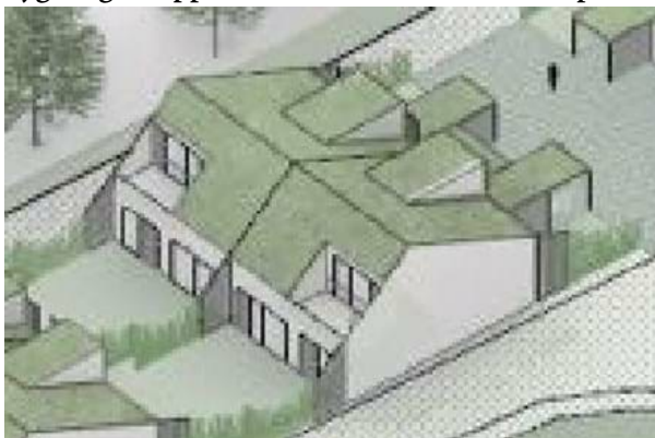
Figur 6 Princip illustration, som viser en indrykket altan med tagflade/gavlmur på 3 sider.
