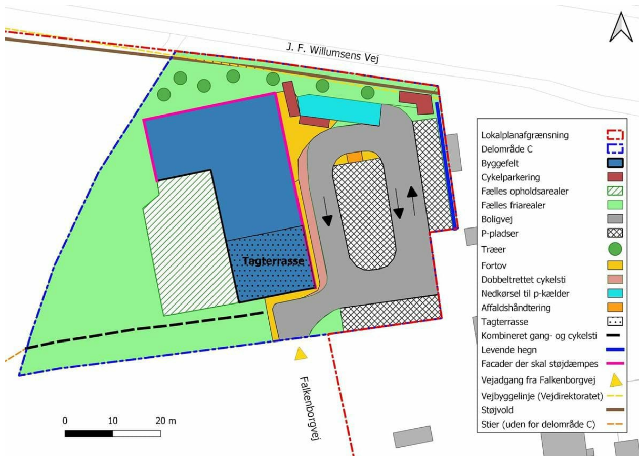
Kortbilag 6 viser arealdisponering inden for delområde C af: byggefelt, vej, sti, parkering og friarealer.
